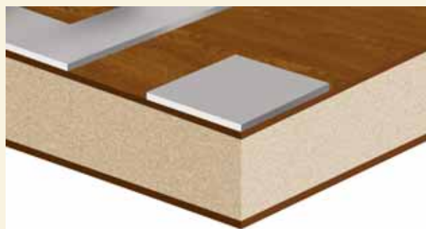
řez HPL výplně s nalepeným nerezovým rámečkem a čtverečkem
